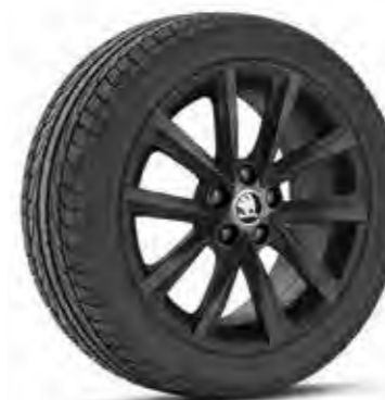
16" kola z lehké slitiny VIGO, černá (disk: 7J × 16" ET46, pneu: 215 / 45 R16)
