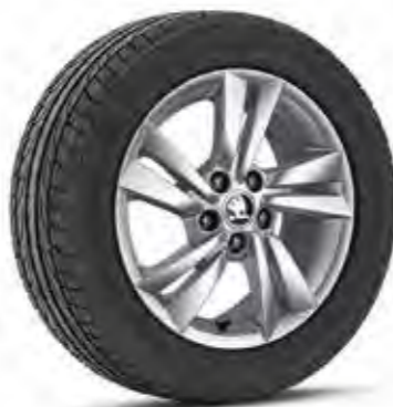
15" kola z lehké slitiny CYGNUS (disk: 6J × 15" ET38, pneu: 185 / 60 R15)
