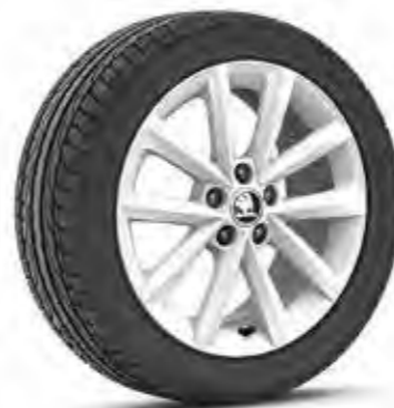
16" kola z lehké slitiny VIGO, bílá (disk: 7J × 16" ET46, pneu: 215 / 45 R16)
