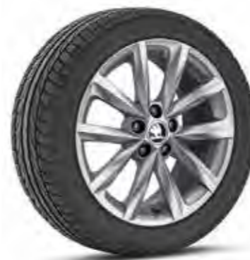
16" kola z lehké slitiny VIGO (disk: 7J × 16" ET46, pneu: 215 / 45 R16)
