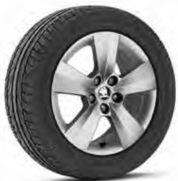
15" kola z lehké slitiny MATONE (disk: 6J × 15" ET38, pneu: 185 / 60 R15)
