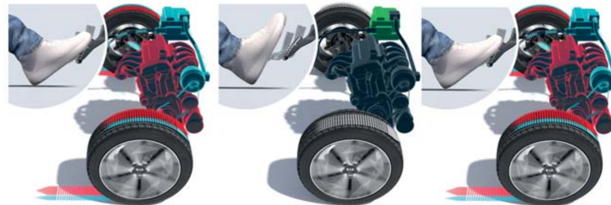
Zjednodušené zobrazení funkce setrvačné jízdy u částečně hybridního pohonu s převodkou iMT.
